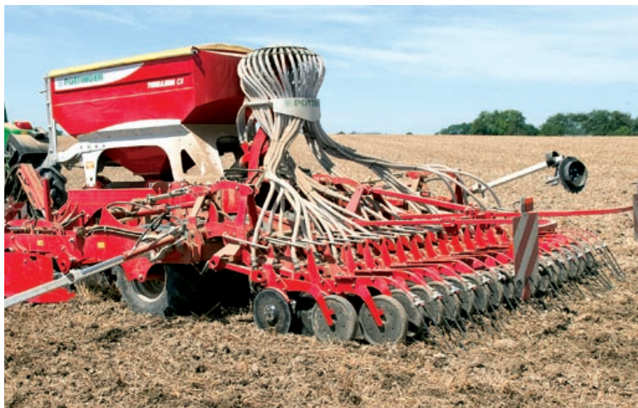
Štvormetrový univerzálny sejací stroj TERRASEM C4.
