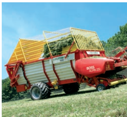
Vůz BOSS ALPIN s rozšířenou nápravou a sníženým těžištěm je vhodný pro sklizeň píce v horských oblastech.
