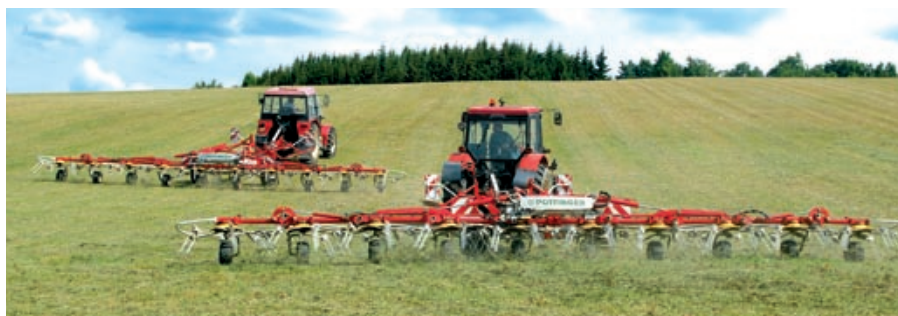
Výkonné desetitorové obrabeče HIT 10.11 T v akci. Každý má pracovní záběr jedenáct metrů.
